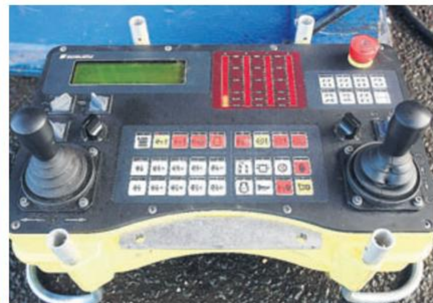
Tagelange Vorbereitungen und endlose Berechnungen gingen dem spannendsten Augenblick voraus: Henry Vandenberg (linkes Bild) muss per hochkomplizierter Funkfernsteuerung (Foto rechts) 60 selbstfahrende Hydraulik-Achsen koordinieren, um das Schiff sicher zu manövrieren. MES
