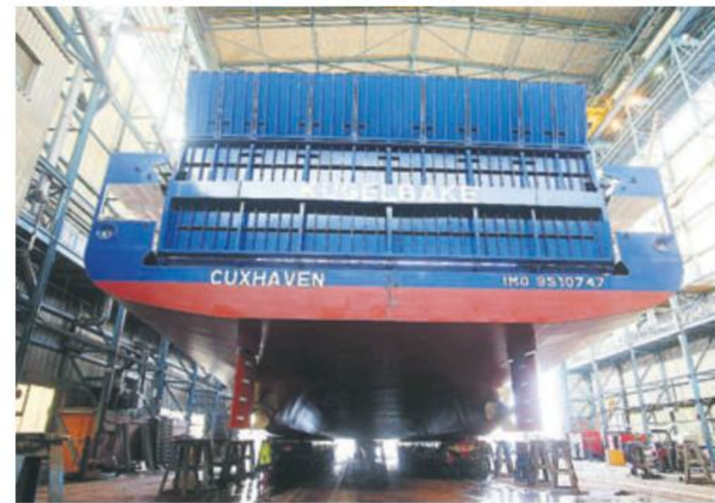
Statt sie in Einzelteilen am endgültigen Standort zusammensetzen, wurde die „Kugelbake“ in der BVT-Halle in Nordbremen komplett gefertigt. Das machte die Verladung schwierig. MES
