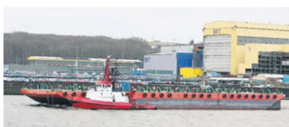
Schon der 86 Meter lange und 27,5 Meter breite Ponton, der mit Schleppkränen über die Weser gezogen wurde und 10 000 Tonnen Tragkraft hat, bot einen spektakulären Anblick. MES
