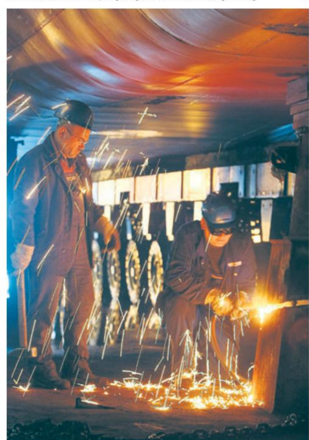
Ein aufregender Moment: Sind die Halterungen erst einmal entfernt, liegt der rund 1300 Tonnen schwere Spezialfrachter nur noch auf den selbstfahrenden hydraulischen Achsen. MES
