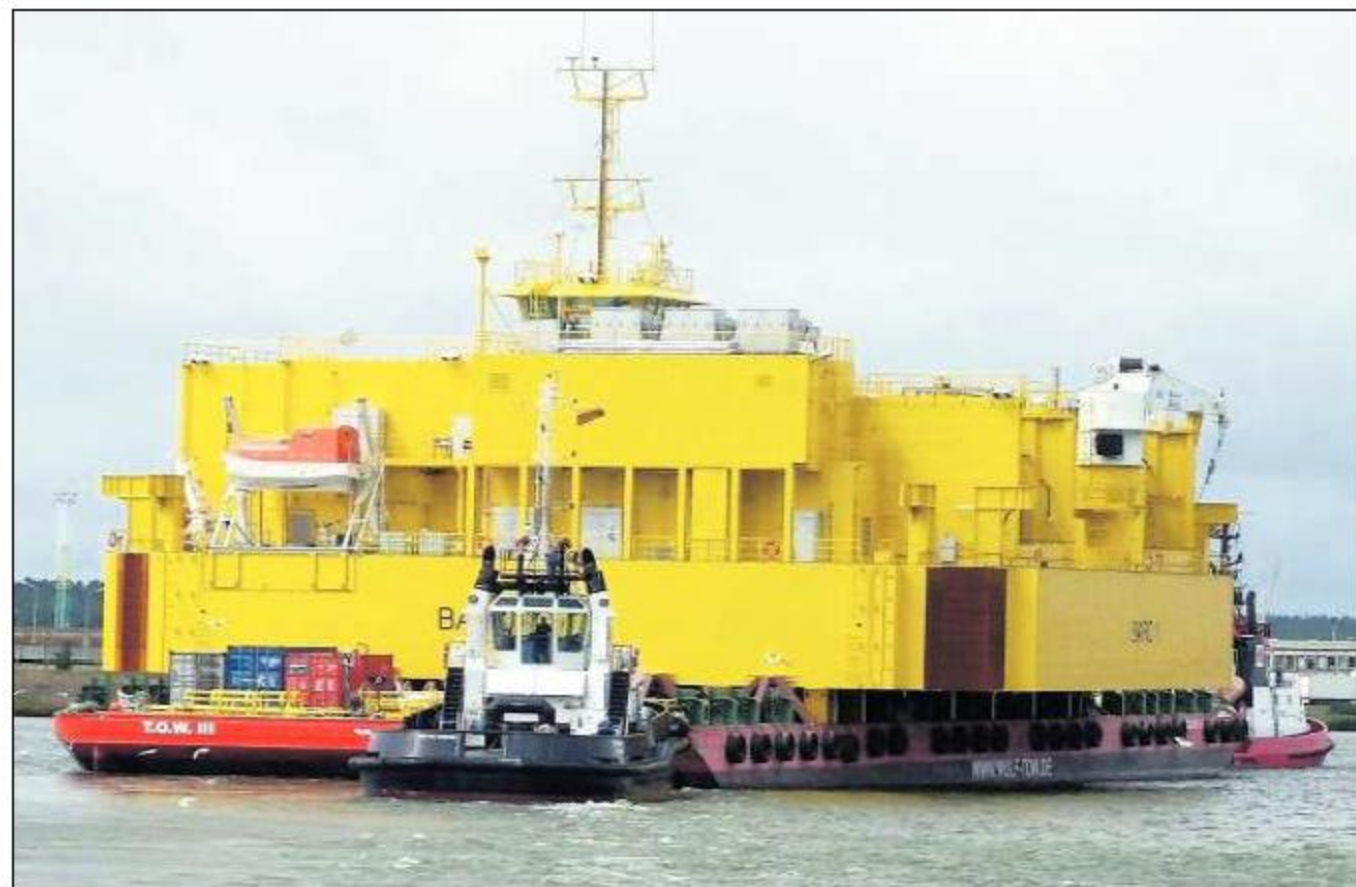
3200 Tonnen wiegt die Plattform, die die Reederei Wulf auf ihrem Ponton „TOW III“ transportiert. Der Bugschlepper „TOW IV“ wird die Fracht in vermutlich 10 Tagen nach 1200 Seemeilen in Belfast abliefern.
