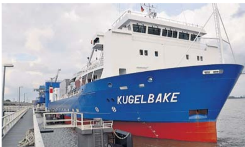
Die Brücke der „Kugelbake“ befindet sich am Bug. Aus diesem Grund kann das Schiff auch sehr hohe Projektladung an Bord nehmen.
